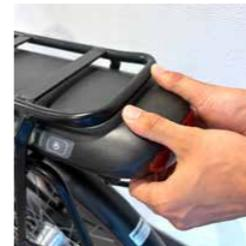
3. Retirez doucement la batterie du socle de la batterie avec les deux mains.
